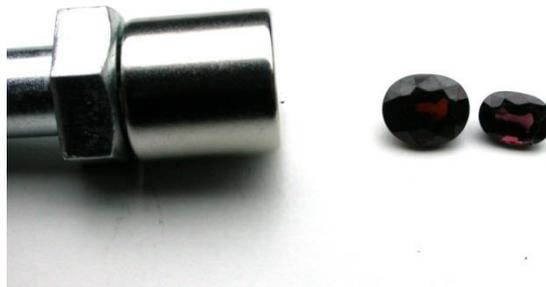
Abbildung 3: Direktmethode – der Magnet wird horizontal an die Steine angenähert
